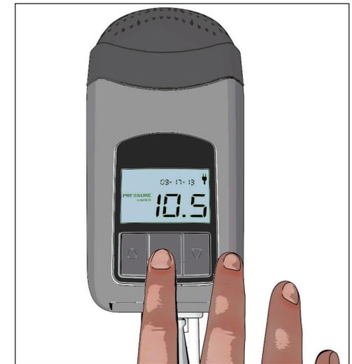
**HINWEIS für Z1:** Die automatische Stoppfunktion stoppt die Therapie, falls das Gerät ein größeres Luftleck zwischen dem Z1-Auslass und der Maske feststellt. Die automatische Stoppfunktion kann sich auch einschalten, wenn die Maske nicht korrekt sitzt. Wenn alle Verbindungen korrekt hergestellt sind, die Maske richtig sitzt und die Start-/Stopp-Taste gedrückt worden ist, wird der automatische Stopp normalerweise nicht aktiv.
